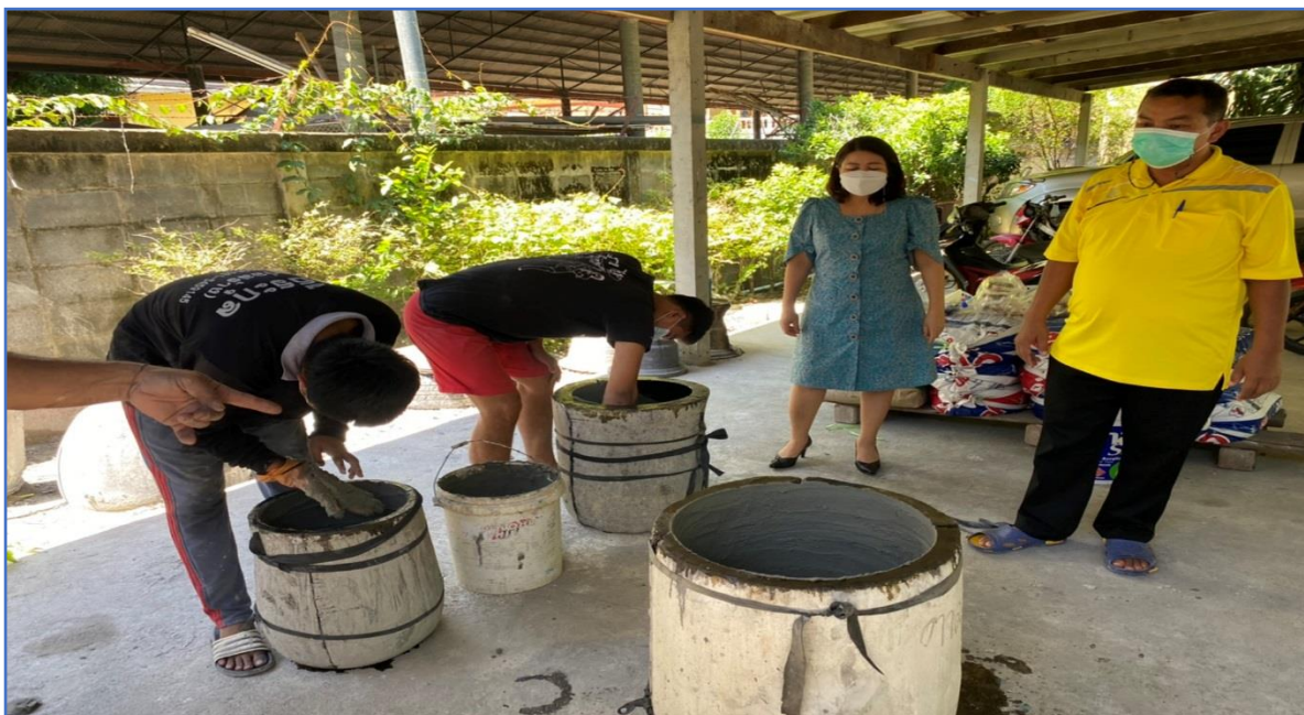
ต่อจากนั้นนำปูนซีเมนต์มาขึ้นปากกระถาง โดยการสวมถุงมือยางแล้วนำปูนมาป้ายให้รอบปากกระถาง แล้วใช้ เกรียงใบโพธิ์วนให้รอบเพื่อความกลม
