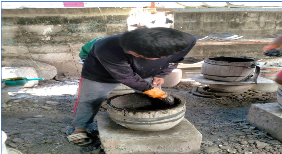
ภาพประกอบ การขึ้นปูนรอบที่ 2 นำปูนที่ผสมไว้ โดยในรอบนี้ให้ผสมน้ำให้เหลว มาทาให้หนากว่าเดิม รองกว่าปูนจะมาด
