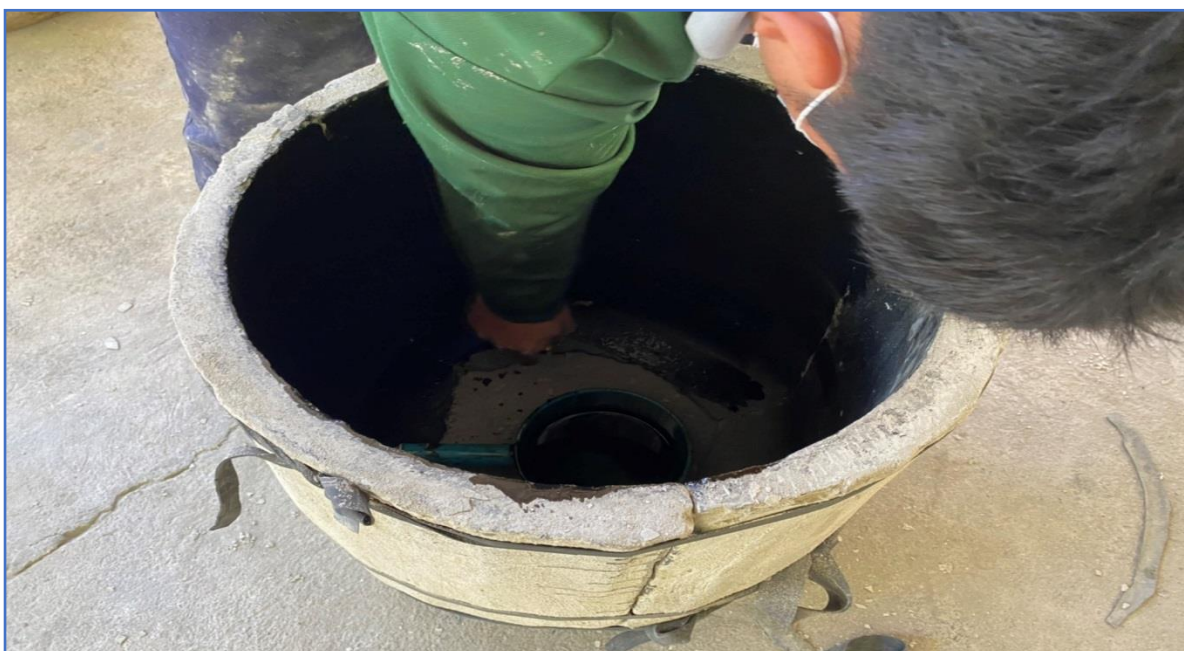
ภาพประกอบ การขึ้นปูนรอบที่ 1 นำปูนซีเมนต์รอบที่ผสมไว้ มาทาวนบางๆ รองนกว่าปูนจะมาด
